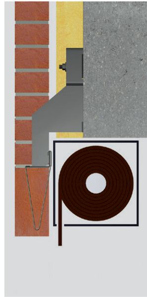
Console met verlengd been voor een rolluikkast
