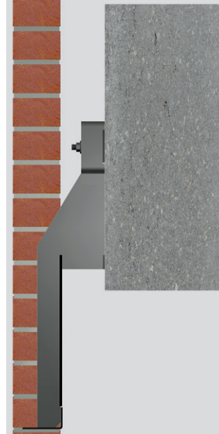
Console met versterigd verlengd been (T of L vorm)
