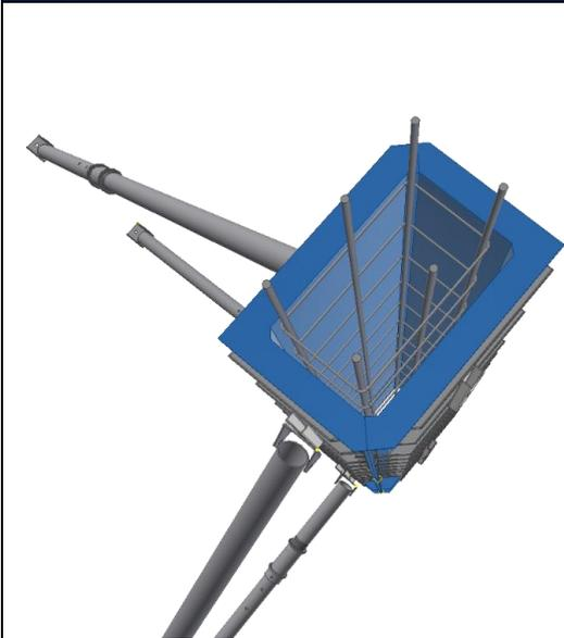
L'aiguille vibrante devra **éviter le contact avec les parois** – accompagner le béton (goulotte caoutchouc ou cheminée de coulage) et adapter la vitesse de bétonnage en fonction du béton.
