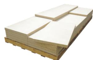
Les panneaux sont livrés sur palette. Pour éviter toute déformation non souhaitée avant la mise en oeuvre, il est recommandé de les transporter dans un camion fermé. Il est essentiel de les stocker à plat et à l'abri des intempéries, dans un endroit sec et ventilé, sur une aire plane et rigide. Les panneaux stockés doivent être suffisamment soutenus pour éviter la flexion prolongée sous le seul poids propre. La hauteur de stockage des panneaux ne doit pas dépasser 2 m.
