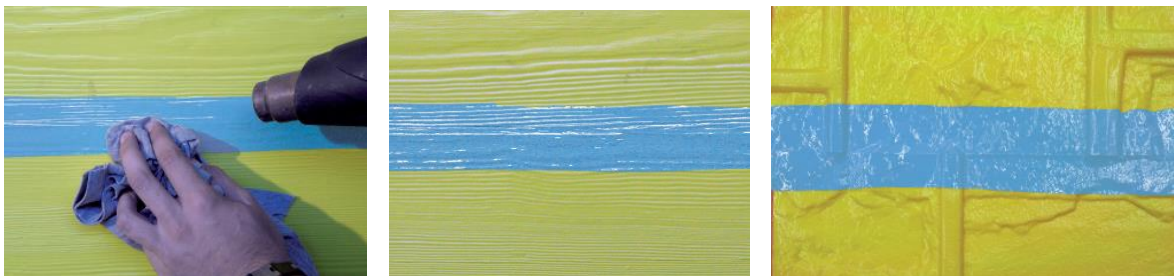
Verbinding tussen de matrijzen bij onregelmatige voegen.
