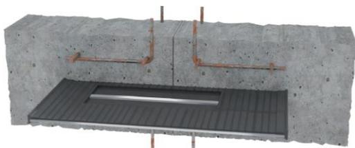
Les joints de reprise internes sont des membranes en PVC dans lesquelles sont intégrées des baleines en acier.
