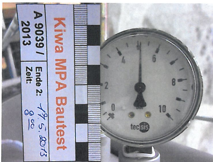
Abbildung 6: Druckdichtigkeitsprüfung der mit Wasser gefüllten Druckglocke bei Raumtemperatur (oben: Manometerstand bei Versuchsbeginn am 14.05.2013 um 08:00 Uhr; unten: Manometerstand nach Versuchsende am 17.05.2013 um 08:00 Uhr)
