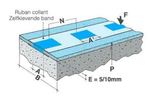
Plots en élastomère (N), de surfaces variables, noyés dans une bande en mousse de polyéthylène (P) de longueur standard de 1 m.
