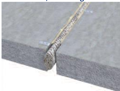
Joint entre dalles
