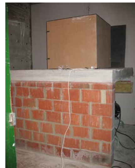
Source d'excitation : Machine à choc dans une boîte limitant la propagation du bruit aérien
