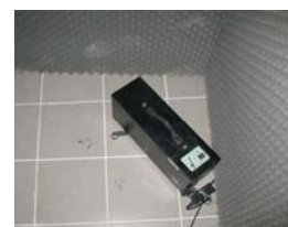
Source d'excitation : Machine à choc dans une boîte limitant la propagation du bruit aérien
